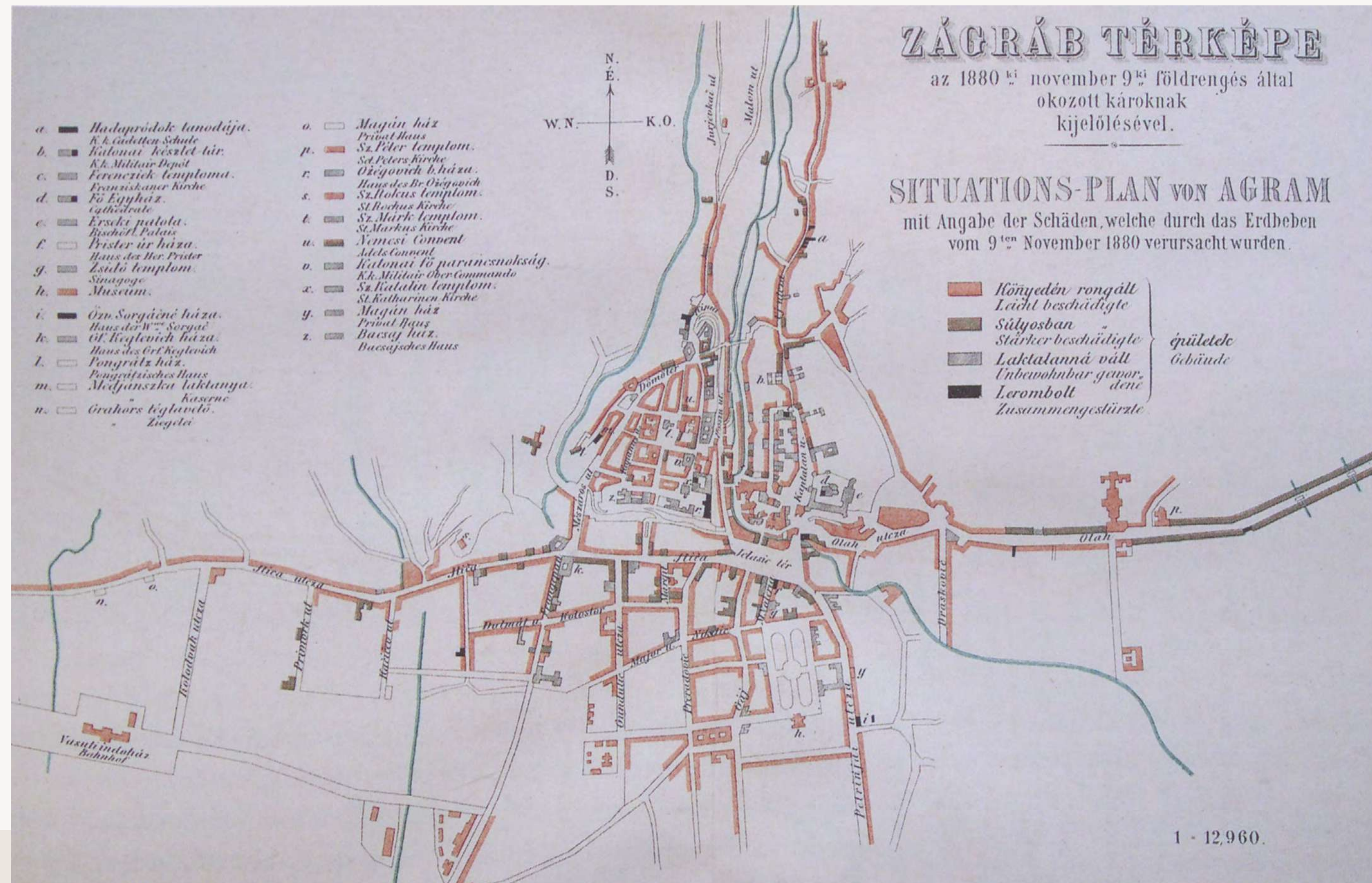
Karta oštećenja zgrada prilikom zagrebačkoga potresa 9. studenoga 1880. godine. Preuzeto iz: Max Hantken von Prudnik, Das Erdbeben von Agram im Jahre 1880. Bericht an das K. ung. Ministerium für Ackerbau, Industrie und Handel , Budimpešta, 1882., pl. XI.
